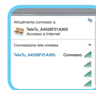
Attendi che il PC si colleghi al router. Il collegamento è attivo quando appare l'indicazione CONNESSO. Adesso puoi staccare il cavo giallo.
