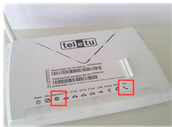
Una volta collegato l'apparecchio telefonico nell'uscita **TEL** potrai già iniziare a telefonare.
