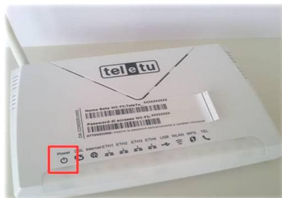
Inizialmente il Router dovrà ricercare il segnale della linea ADSL, quindi la spia **DSL** sarà lampeggiante. Dopo circa 1 minuto, quando il segnale ADSL sarà stabile, la spia **DSL** emetterà una luce verde fissa.
