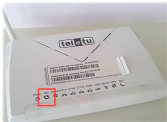
Quando la spia **DSL** sarà diventata fissa e stabile anche le spie **Internet** e **TEL** si accenderanno emettendo una luce verde fissa, perché il Router avrà completato correttamente la configurazione automatica.
